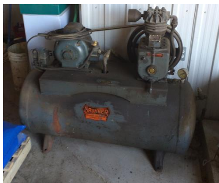
#1 Compresseur à air « Brunner » 5Hp
